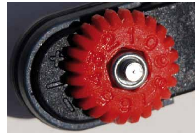
Particolare della ghiera numerata per la pre taratura della tensione di sgancio. Si notano il più e il meno che indicano rispettivamente le direzioni verso le quali girare la ghiera per stringere o allentare la tensione
