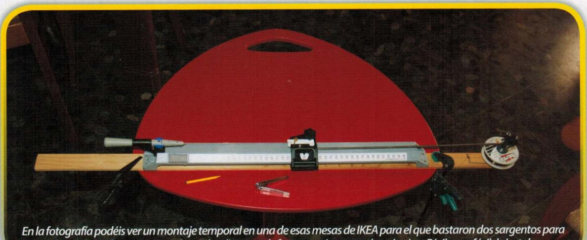
En la fotografía podéis ver un montaje temporal en una de esas mesas de IKEA para el que bastaron dos sargones para sujetar la madera a la que va pegado con los discos a tal efecto que vienen con la máquina. Fácil, muy fácil de instalar.
